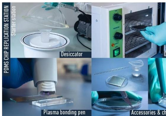
取代传统的大型等离子体清洗机，简化实验内的PDMS芯片键合步骤，节省时间空间和降低成本。
