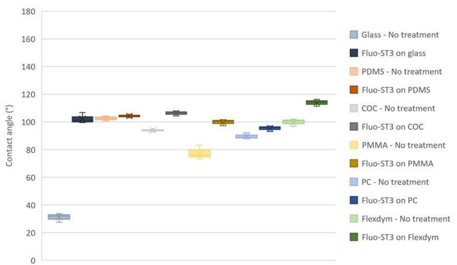
无论测试何种材料，Fluo-ST3 表面处理都能提高疏水性。
